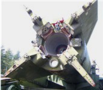
*photo of actual SCUD -missing exhaust vanes
