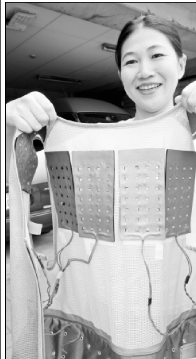
عازضة تقدم نموذجاً تجريبياً لسرة مبردة برفائق من اشباه الموصلات التي تستخدم في تبريد اجهزة الكمبيوتر. وقد تم تصميم هذه السرة للمرضى وكبار السن ممن لا يستطيع اجسامهم ضبط درجة حرارتها
