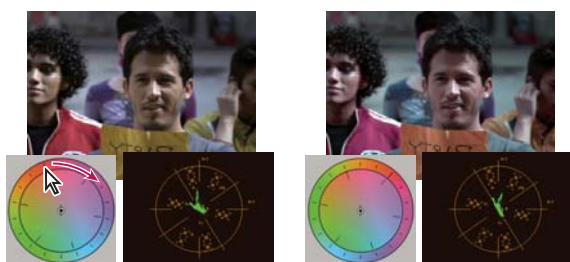
Déplacer le cercle extérieur de la roue chromatique (gauche) modifie l'angle de la teinte (droite).
