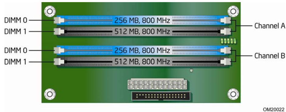
图 14. 四条 DIMM 下的双通道内存配置
