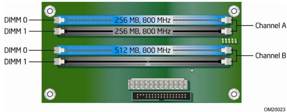
图 15. 三条 DIMM 下的双通道内存配置
