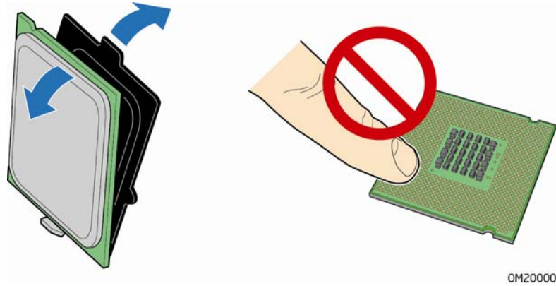
图 9. 从处理器保护罩中取出处理器
