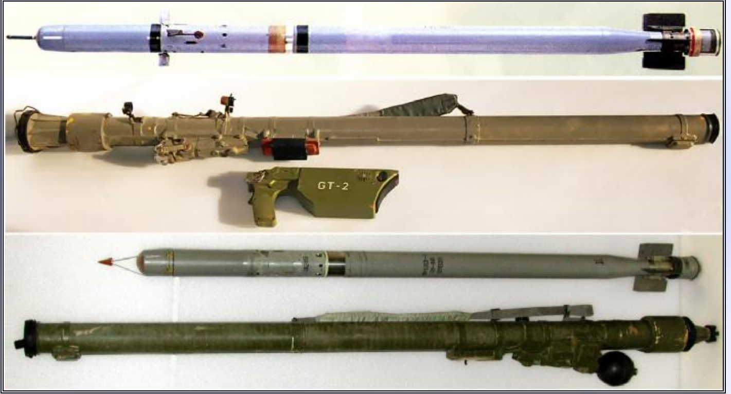
رسم 15. فوق: صاروخ روسي الصنع إيغلا 9M39 مع القاذفة 9K38، إس أي - 18 غروز (SA-18 Grouse). تحت: صاروخ روسي الصنع إيغلا 1 - 9M313، مع القاذفة 9K310، إس إي - 16 غيملت (SA-16 Gimlet) و هو نسخة مصغرة من إس - 18 غروز.
