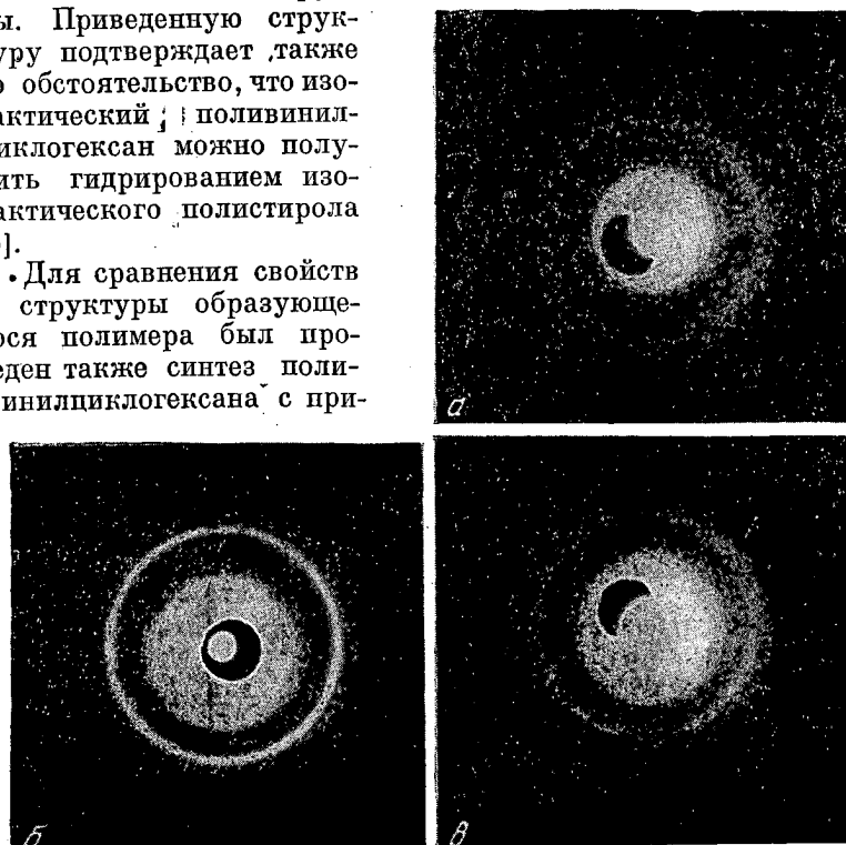
Рис. 2. Рентгенограмма кристаллического поливинилциклогексана, полученного в присутствии:
