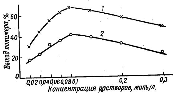
Рис. 5. Зависимость выхода полигексаметиленсебацитамида от способа получения полимера на границе раздела фаз 1 — при перемешивании гетерогенной системы, 2 — при непрерывном извлечении
