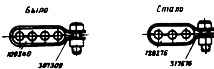
Фиг. 210. Зажим для крепления трубок замера давления масла в муфте выключения.
