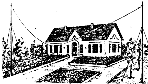
Фиг. 5. Антенное устройство стационарной радиостанции. Вариант 3-й.
