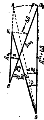
Рис. 3. Определение дальности до цели и угла переноса при глазомерном переносе огня
