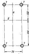
Рис. 4. Сверление отверстий для установки контактора типа КМВ 521 на плите a — вертикальная установочная ось; b — горизонтальная установочная ось
