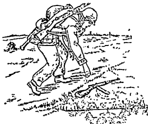
Rys. 31. Mina-niespodzianka o działaniu naciagowym połączona z pistoletem maszynowym
