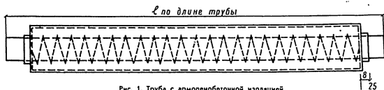
Рис. 1. Труба с армопенобетонной изоляцией
