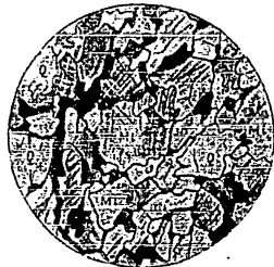
Рис. 9. Гнейсовидный аляскитовый гранит. Структура гранобластовая с элементами катаклаза. Шлиф № 22а, инк. +, X 15.
