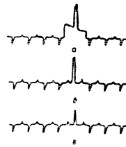
Рис. 77. Установка задержки импульса запуска задерживаемых разверток
